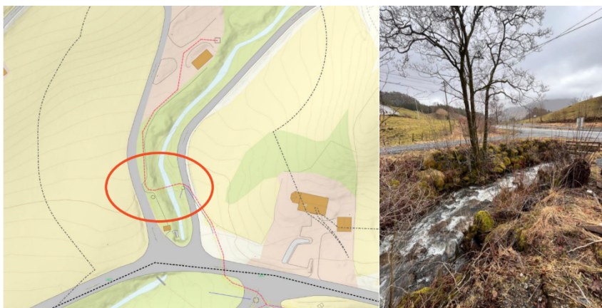
Figur 2: Venstre: Planlagt krysningstrase for vannledning over Sørhuselva oppstrøms E134 markert med rød stiplet linje. Høyre: Kantvegetasjonen oppstrøms E134 består av en stor svartor og yngre skudd av svartor og andre løvtrær.
